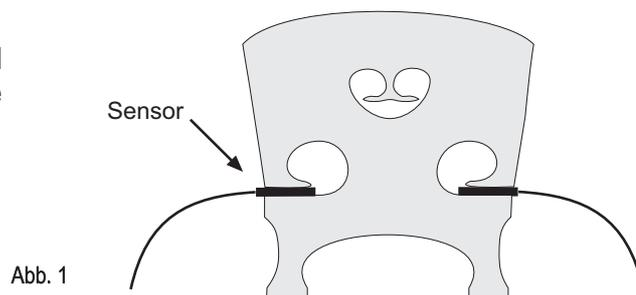
2. Sitzt der Tonabnehmer zu lose, benutzen Sie die beigegefügte Kupferfolie und umwickeln Sie den Tonabnehmer wie auf der Abb. 2.
